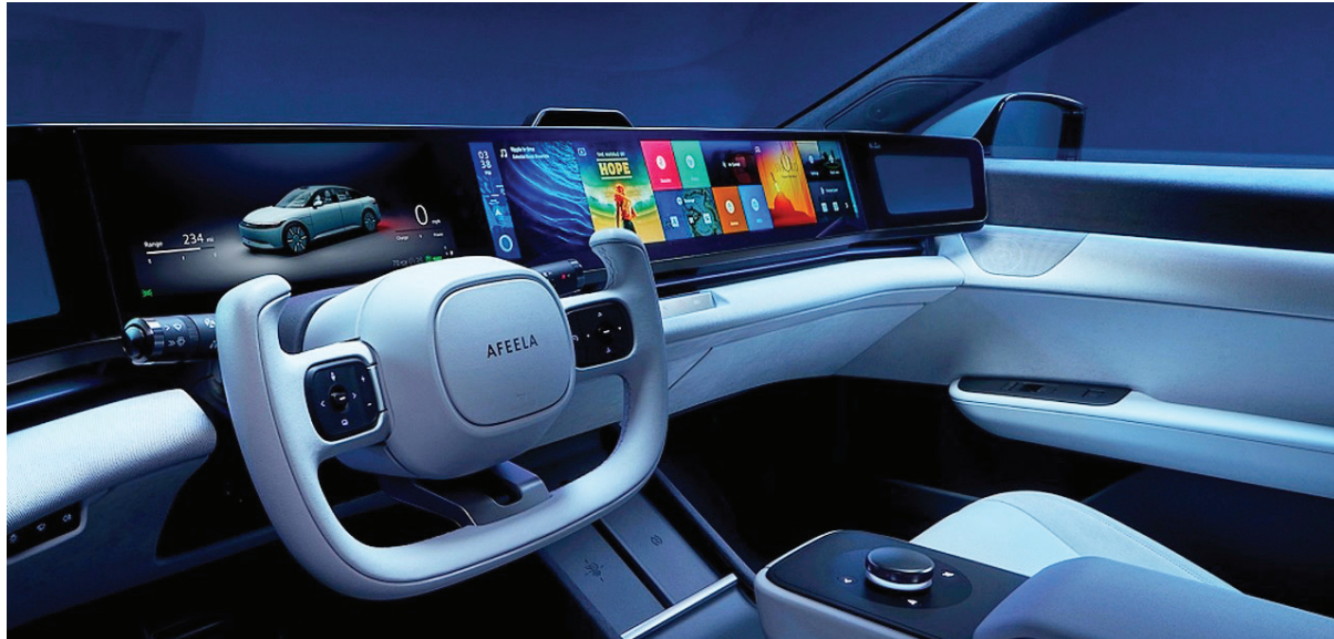
El tablero está dominado por una gran pantalla panorámica que se extiende de extremo a extremo, integrando instrumentación, navegación, entretenimiento y controles del vehículo.
