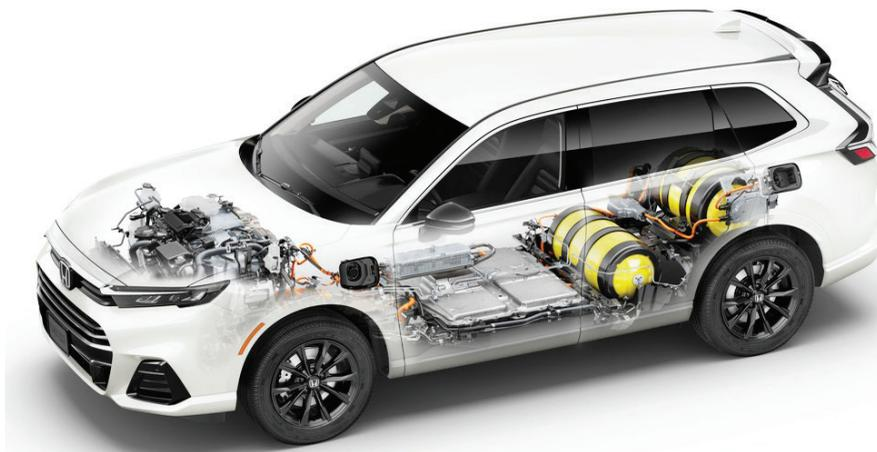
En este corte transversal se aprecia la ubicación del sistema eléctrico enchufable de pila de combustible de hidrógeno en el modelo Honda CR-V e:FCEV 2025 que entra en producción este año.
