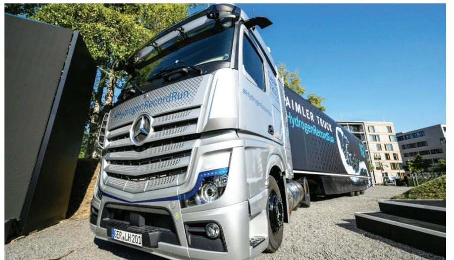
**El prototipo de camión a hidrógeno GenH2** de Daimler Truck llega a Berlín tras haber recorrido más de 650 millas (unos 1.000 kilómetros) con una sola carga.
