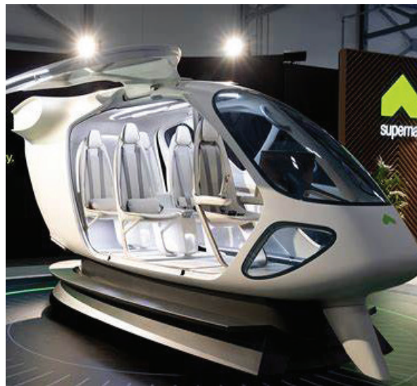
La cabina del taxi aéreo eVTOL , para cuatro pasajeros, ofrece un generoso espacio libre e incluye materiales como fibra de carbono reciclable, termoplástico reforzado y cuero duradero fabricado a base de plantas.
