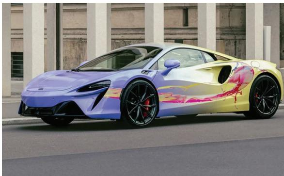
**El McLaren Artura es el primer híbrido puro** fabricado en Woking, que cuenta con un conjunto motriz compuesto por un motor eléctrico y bloque V6.
