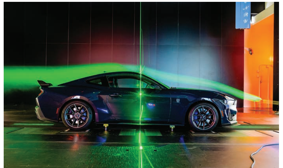
Ford tiene un nuevo túnel de viento de última generación llamado Rolling Road Wind Tunnel (RRWT), que permite mejorar la investigación y desarrollo aerodinámico de los vehículos eléctricos, híbridos y de gasolina de próxima generación de Ford.
