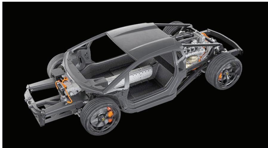
**Una mirada al diseño futurista** del Lamborghini LB744 nos explica todo sobre la construcción de su chasis con fibra de carbono y materiales revolucionarios. FOTO: LAMBORGHINI
