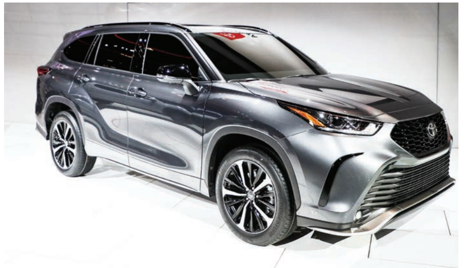
Un motor de cuatro cilindros de 2.5 litros se complementa con dos motores eléctricos (uno al frente y otro en la sección posterior) para impulsar los SUV Toyota Highlander Hybrid Bronze Edition 2022 FOTO: TOYOTA
