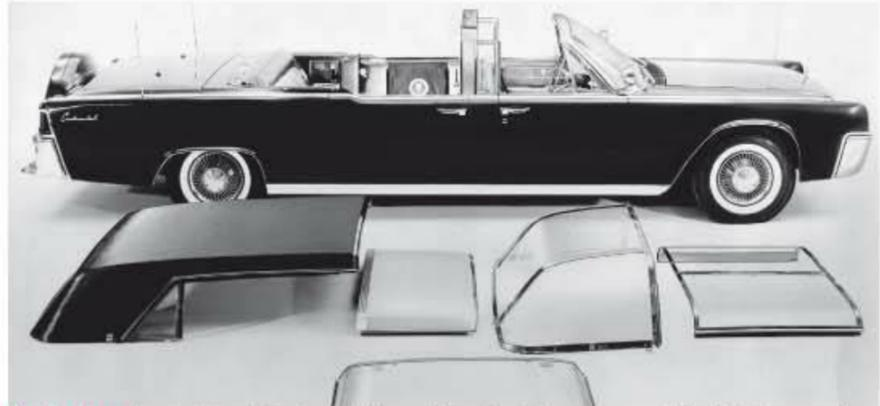
La fabulosa limosina Lincoln Continental del presidente John F. Kennedy que usó desde 1961 muestra desarmado en el piso las partes del techo transparente de los compartimentos, así como sus combinaciones para la parte posterior y delantera. FOTO: FORD MOTOR CO. / AP
