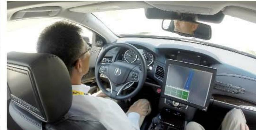
El conductor de un Acura RLX 2016 pone sus manos en las rodillas mientras las cámaras y los múltiples sensores del vehículo monitorean la conducción sin salirse de los carriles de la pista. FOTO: AP
