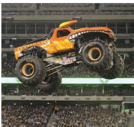
Las camionetas de Monster Jam se construyen para utilizar incrementos de velocidad cortos y de alta potencia pueden dar saltos de más de 9 m y recorrer una distancia de aproximadamente 40 m en el aire. FOTO: CORTESÍA.
