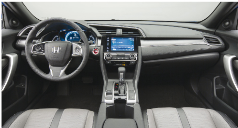
La cabina cuenta con un nuevo panel de instrumentos suave al tacto y de una sola pieza con costuras moldeadas. FOTO: HONDA
