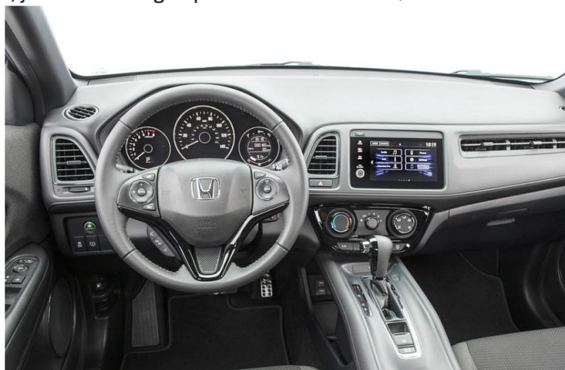
En el tablero de instrumentos destaca una nueva pantalla de Display Audio con botón para el volumen, integración de Apple CarPlay y Android Auto. FOTO: HONDA
