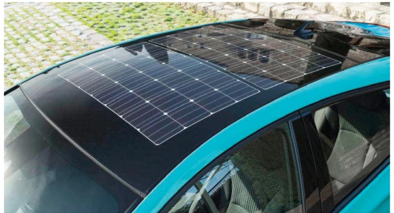
Los paneles solares generadores de electricidad serán incorporados en adelante al techo o al capó de los vehículos Hyundai. Esta tecnología puede ser compatible con los vehículos de combustión interna, híbrida y eléctrica. FOTO: HYUNDAI
