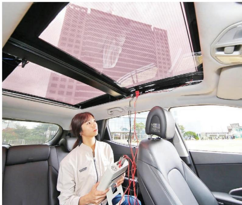
Los paneles solares son semitransparentes y se montan en el techo solar panorámico, dando una luminosidad completa incluso cuando se están recargando. FOTO: HYUNDAI
