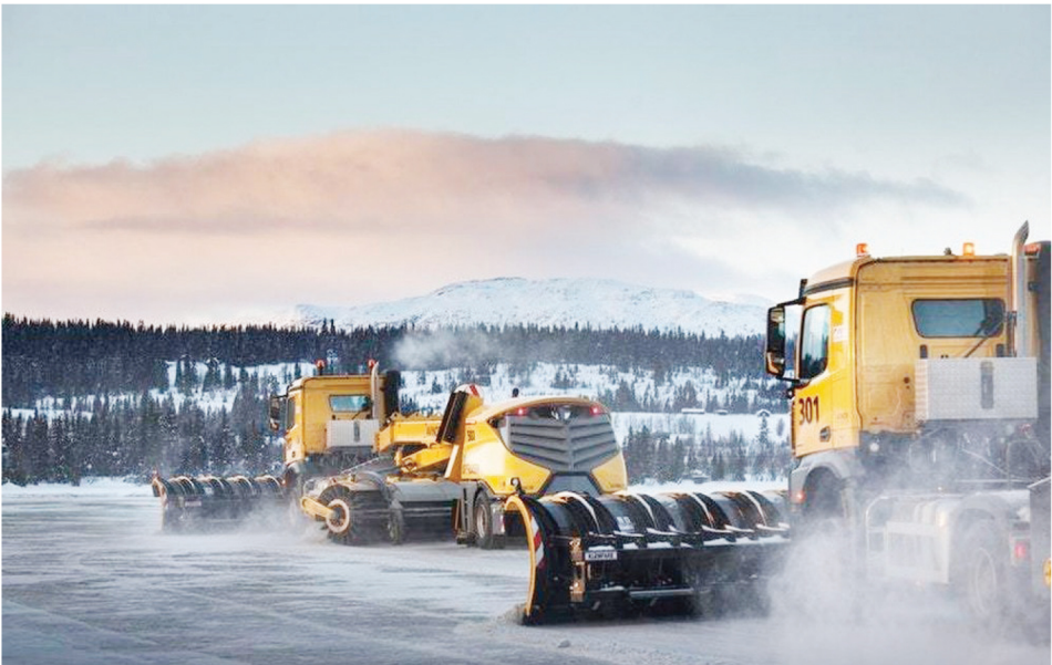
Primer plano de las máquinas quitanieves autónomas cuya tecnología ha sido probada repetidas veces en el aeropuerto Fagernes de Oslo y que en el cercano invierno entrarán en acción de manera real.
