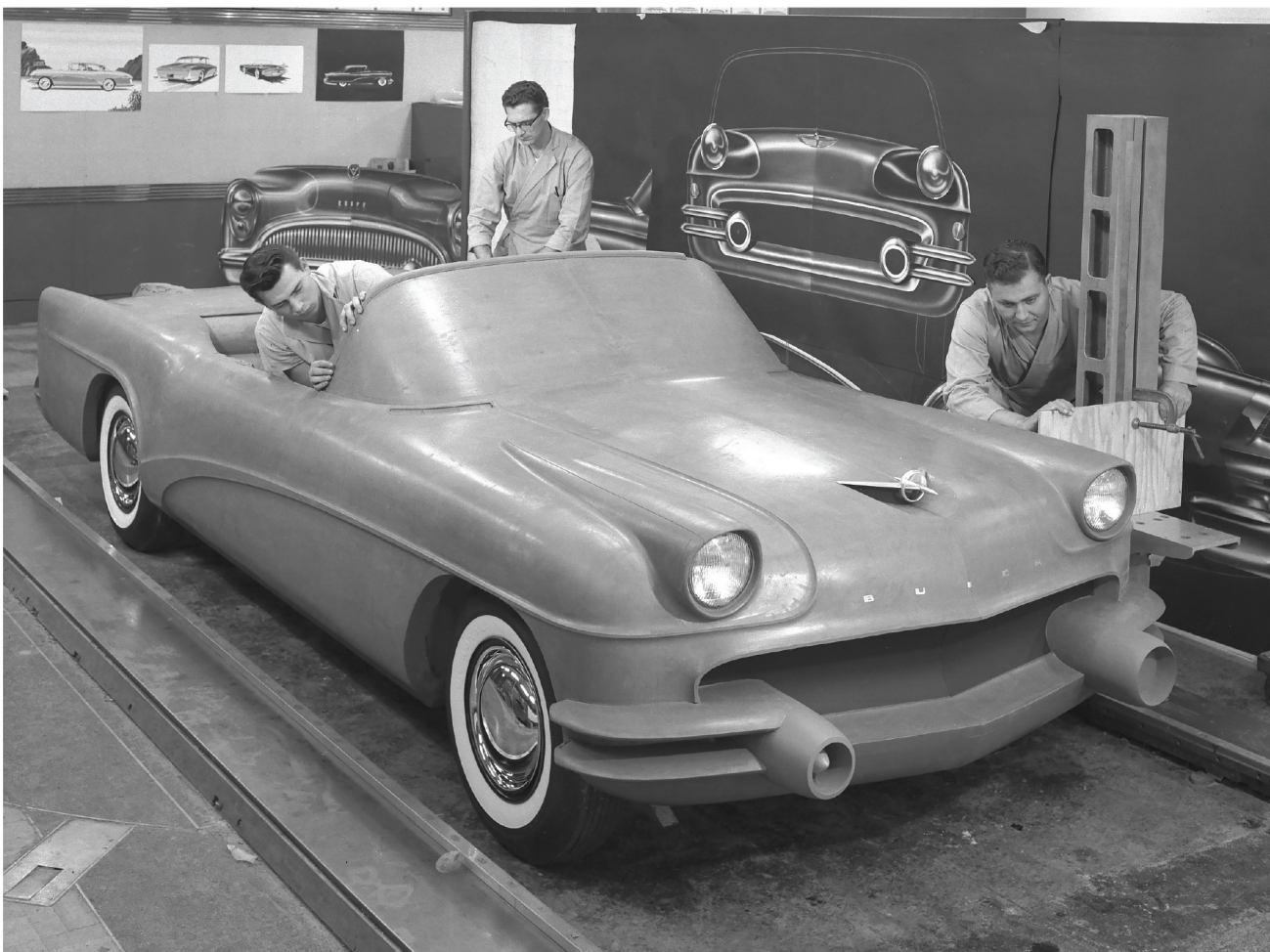
Escultores de General Motors dan forma a un modelo totalmente de arcilla en 1954. Las casas automotrices tienen la tecnología más avanzada, pero dicen que no hay nada mejor que la arcilla para trabajar en los modelos nuevos. Empezaron a hacerlo en la década de 1930 y continúan haciéndolo hoy en pleno Siglo XXI. FOTO: GENERAL MOTORS / AP
