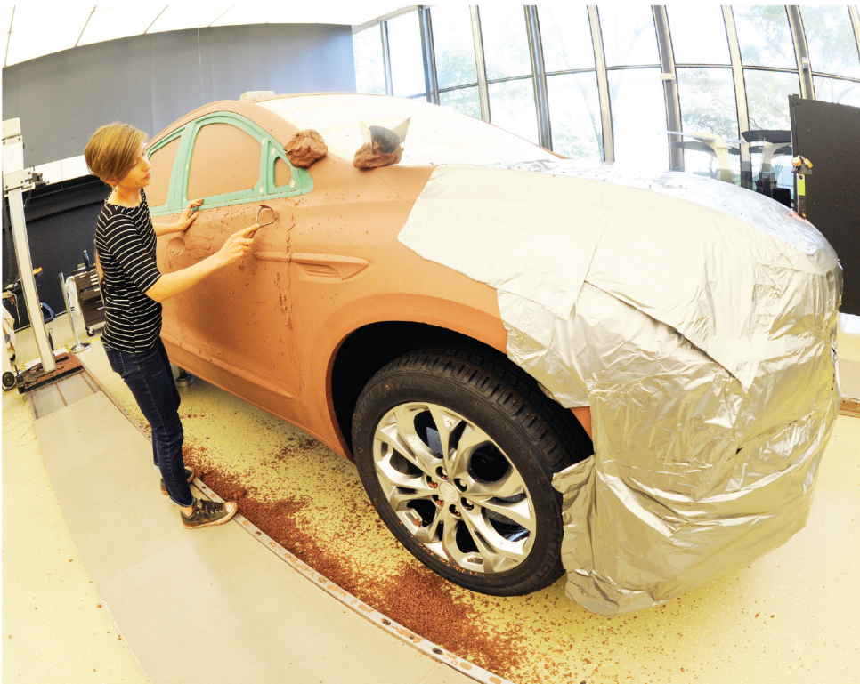
La escultora creativa Gianna Ball , de General Motors, trabaja con arcilla sobre el modelo de un Buick Enclave 2018, en el Centro Tecnológico de GM en Warren, Michigan. FOTO: JOSÉ JUÁREZ / AP
