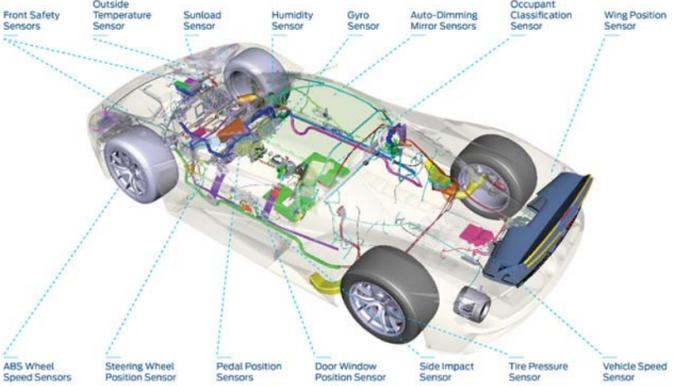
La maqueta muestra los sensores electrónicos del nuevo Ford GT que lo hacen muy admirado por los conocedores. FOTO: FORD MOTOR
