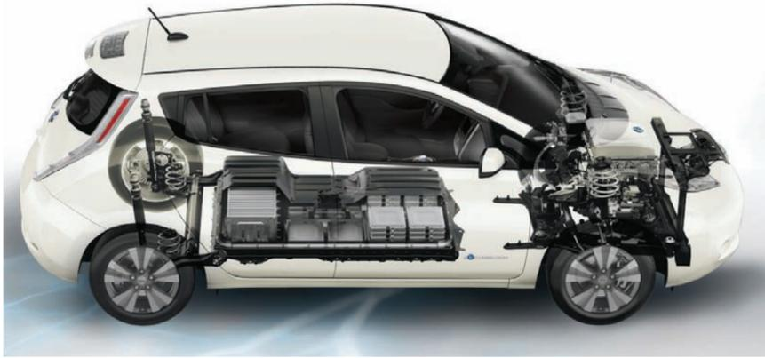
**El esquema** muestra la ubicación de las baterías de iones de litio compactas y ligeras de los Nissan Leaf. Dichas baterías son diseñadas para una nueva vida y pueden ofrecer electricidad durante 10 años más.
