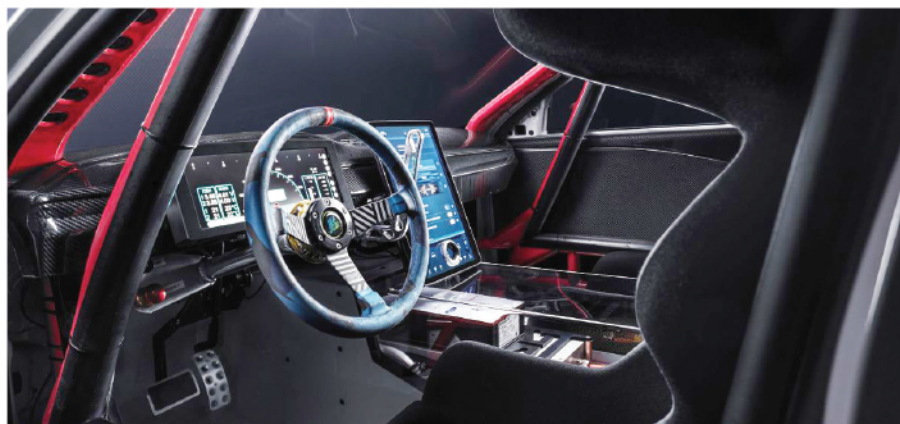
Desde la cabina del Ford Mustang Mach-E se dirige la enorme potencia de 1,400 hp generada por sus siete motores eléctricos.
