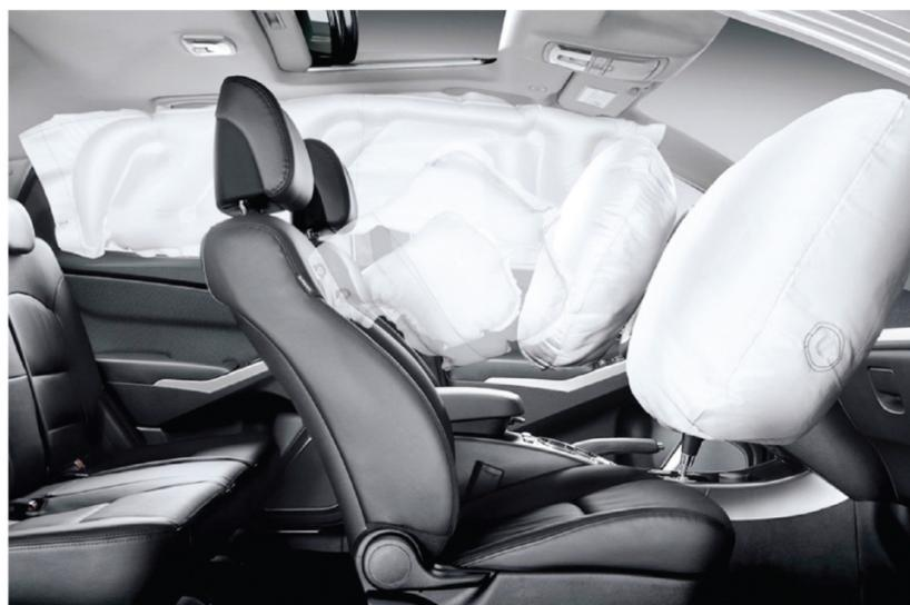
En esta representación se muestran desplegados los diferentes tipos de airbag (frontal, lateral y cortina) que tiene cada vehículo.
