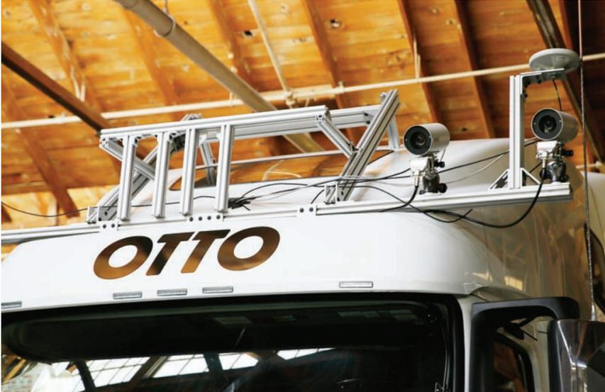
**Cámaras y sensores instalados** en el techo de la cabina de un camión autónomo experimental de la firma Otto el 12 de mayo en San Francisco. Los humanos tomarían el volante solo en los tramos urbanos.
