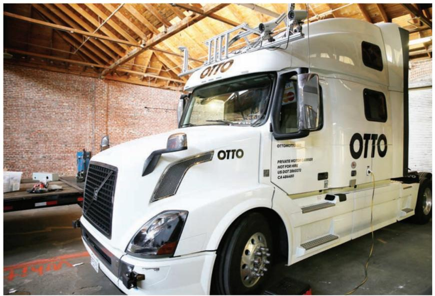
**Este camión autónomo experimental** de la empresa Otto de San Francisco dotado con software, sensores, láser y cámaras está listo para nuevas pruebas en carreteras.
