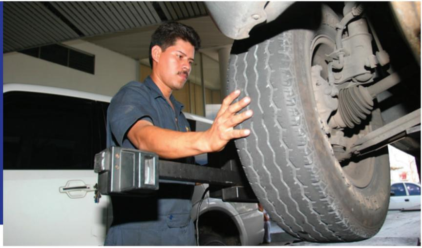
**El desgaste** irregular de las llantas del carro indica la necesidad de una alineación de llantas. Por eso es necesario revisarlas periódicamente, incluyendo la presión y banda de rodamiento. FOTOS: CORTESÍA
