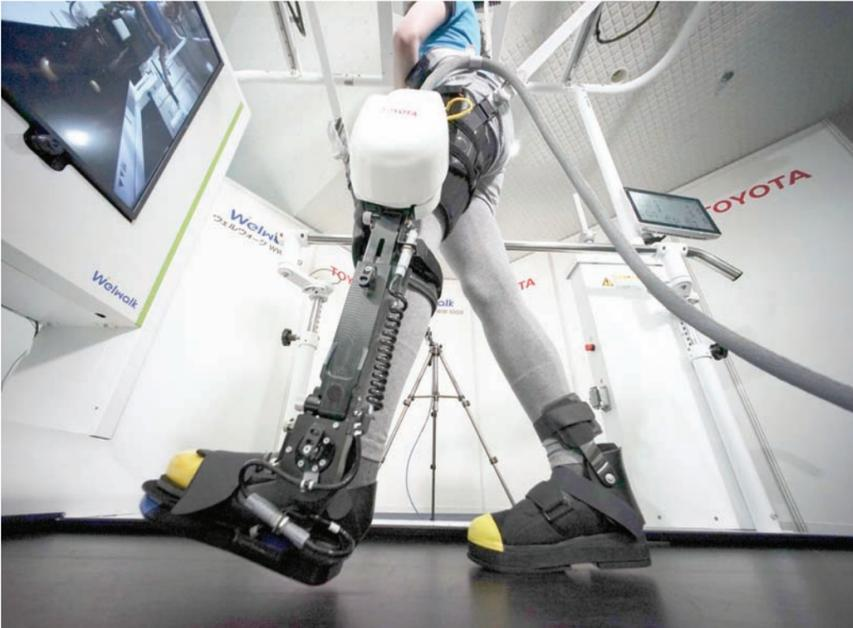
Primer plano del sistema principal y monitor del Welwalk WW-1000 de Toyota, donde se observa cómo esa estructura robótica se adosa a la pierna para ayudar a las personas que sufren parálisis parcial.
