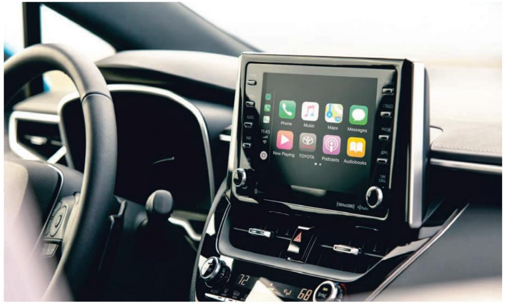
El panel de instrumentos muestra una pantalla táctil multimedia de 8 pulgadas en alta resolución estándar. La pantalla en el conjunto del centro proporciona acceso a los controles del audio, la navegación, teléfono inteligente y las aplicaciones de Entune 3.0.
