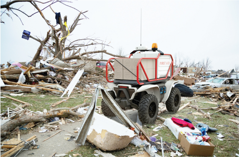
El prototipo “Honda Autonomous Work Vehicle” está diseñado para servir como una gran ayuda para operar en zonas devastadas por incendios, huracanes y otros desastres naturales.
