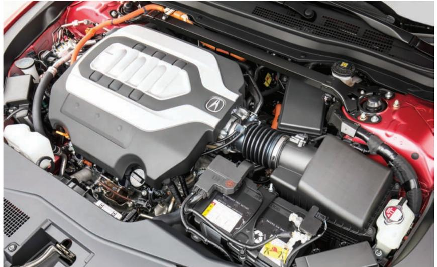
Un motor V-6 de inyección directa se integra con los tres motores eléctricos del RLX Sport Hybrid SH-AWD de Acura. FOTO: ACURA
