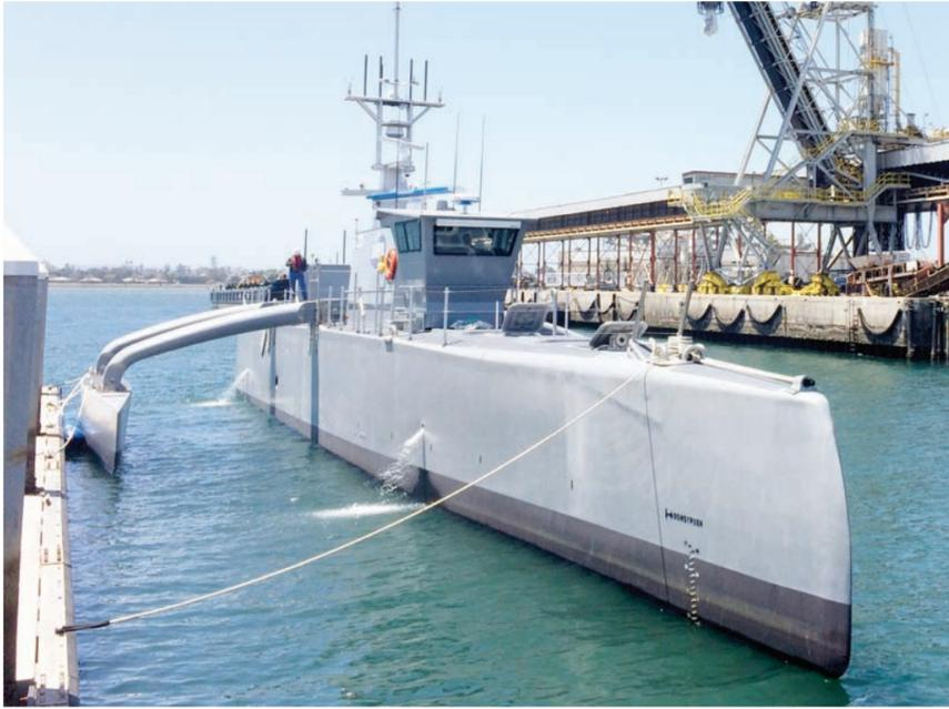
El Sea Hunter, una embarcación de conducción autónoma de la Armada de los Estados Unidos, anclado en un terminal marítimo en San Diego, California. El Pentágono prueba esta nave para viajar miles de millas sin un solo tripulante.
