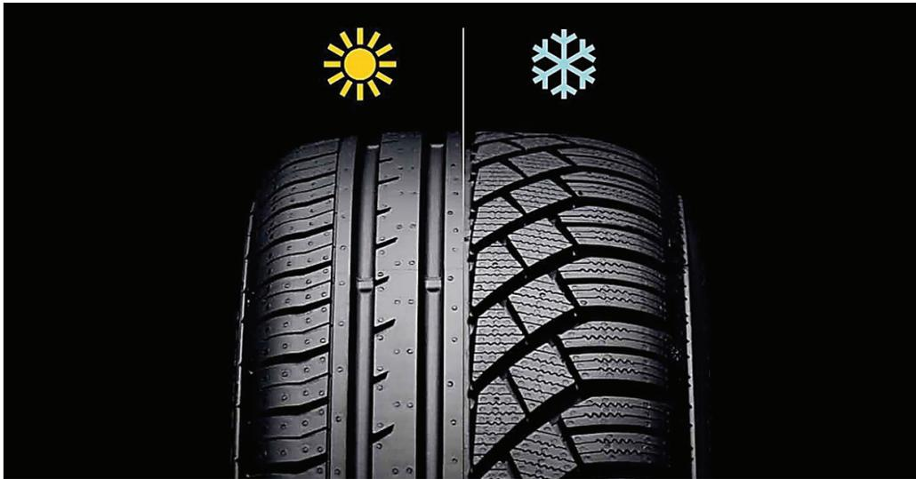
En es esquema se observa las bandas de rodadura de los neumáticos Bridgestone de verano (izquierda), que en esta época calurosa son más eficientes en frenado y duración que la rodadura de los neumáticos de invierno de la misma marca (derecha). FOTO: AUTOPROYECTO
