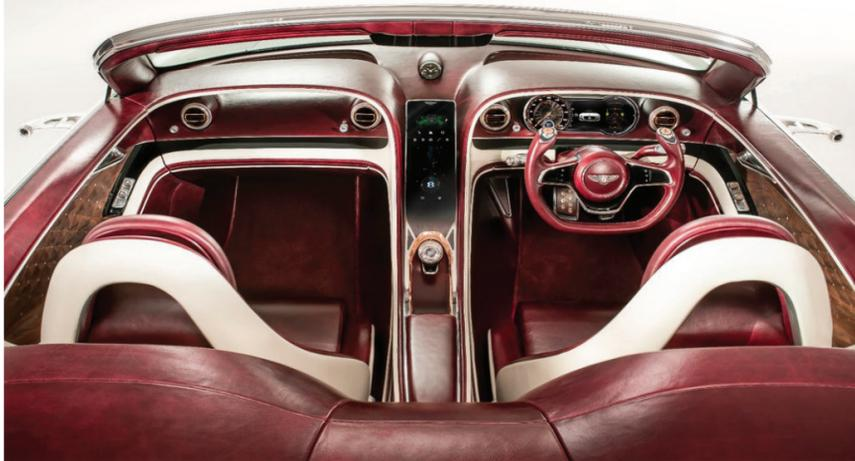
La consola central del Bentley eléctrico está hecha totalmente de un display OLED curvo. Incluso el pasajero cuenta con un panel de control con acceso a correo electrónico, redes sociales y entretenimiento. FOTO: BENTLEY
