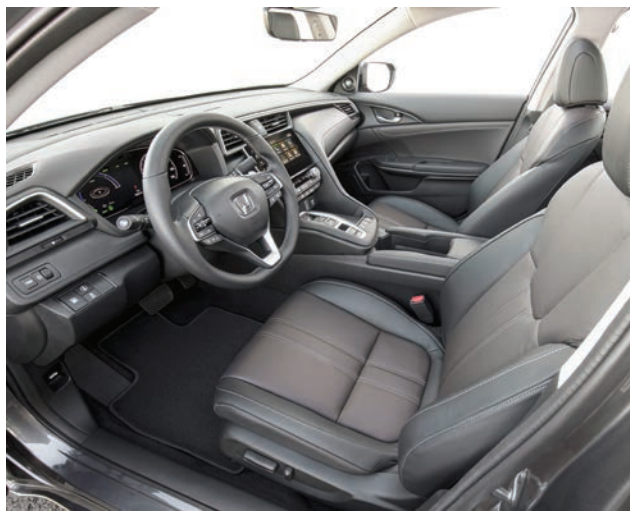
Además del panel de instrumentos táctil, el Insight trae asientos esculpidos ergonómicamente e instrumentos de medición del conductor en una pantalla digital a color TFT de 7 pulgadas. FOTO: HONDANEWS.COM
