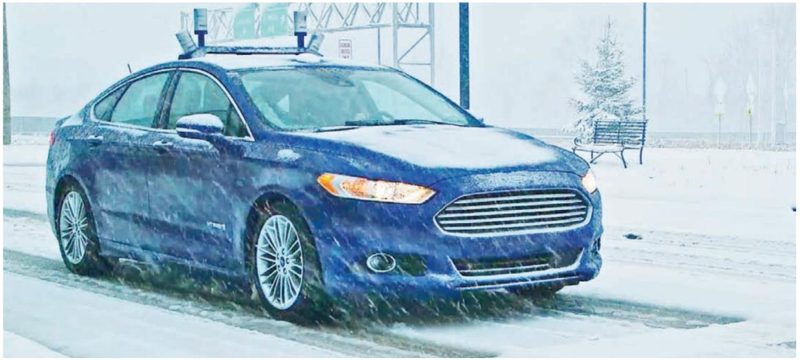
Ford es el primer fabricante de automóviles en realizar pruebas públicas de funcionamiento de vehículo autónomo en la nieve.
