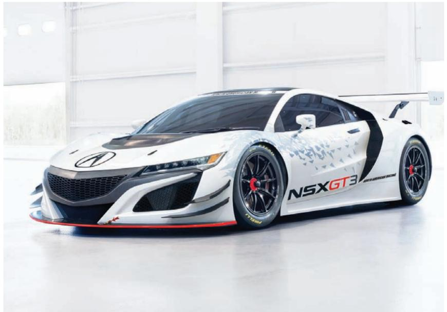
En un gran pabellón del Auto Show de New York se presenta el nuevo bólido de carrera de Acura, que cuenta con un gran alerón posterior integrado y rejillas de ventilación grandes en el capó para un enfriamiento eficiente del motor, entre sus componentes aerodinámicos.
