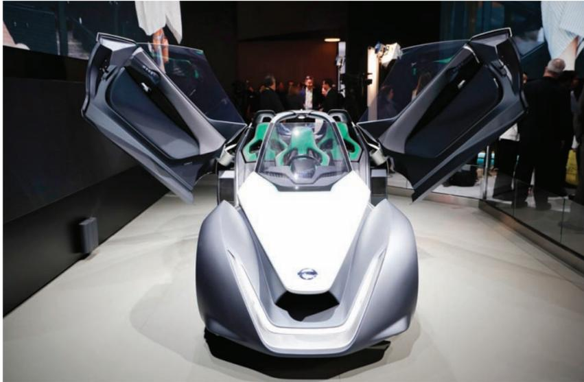
Con sus puertas abiertas con articulación posterior y en ángulo diedro, el Nissan BladeGlider proporciona una fantástica entrada y salida del coche. FOTO: JAE C. HONG / AP
