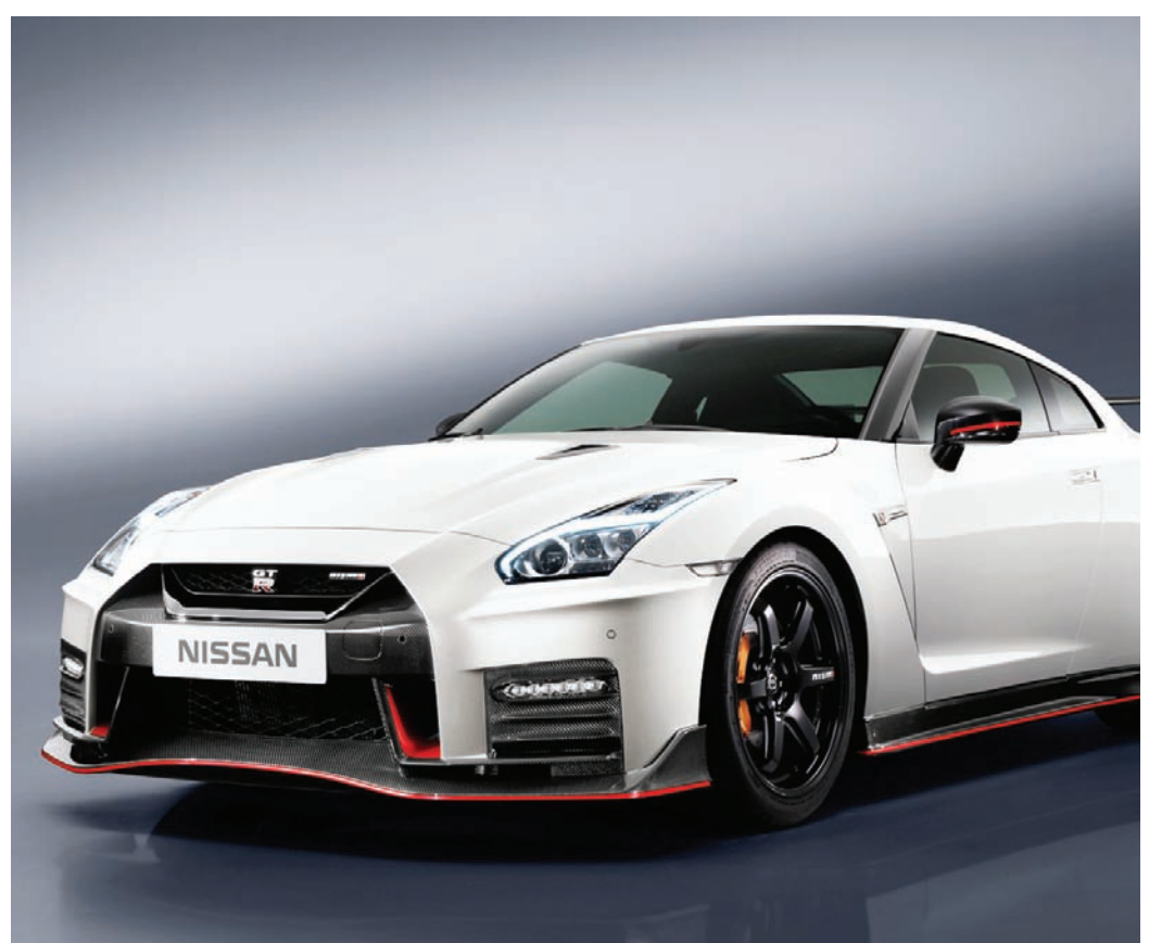
El Nissan GT-R Nismo 2017 lleva parachoques, espejos retrovisores y alerones en fibra de carbono que disminuyen su peso y aumentan su potencia. FOTO: NISSAN
