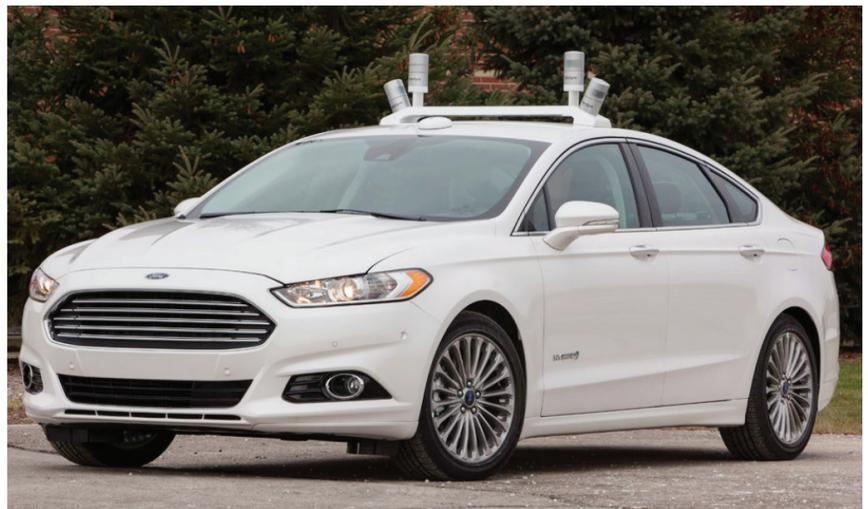
Los ingenieros de Ford prueban un vehículo Fusion, para lo cual utilizan los sensores LiDAR de Velodyne de última generación. FOTOS: FORD
