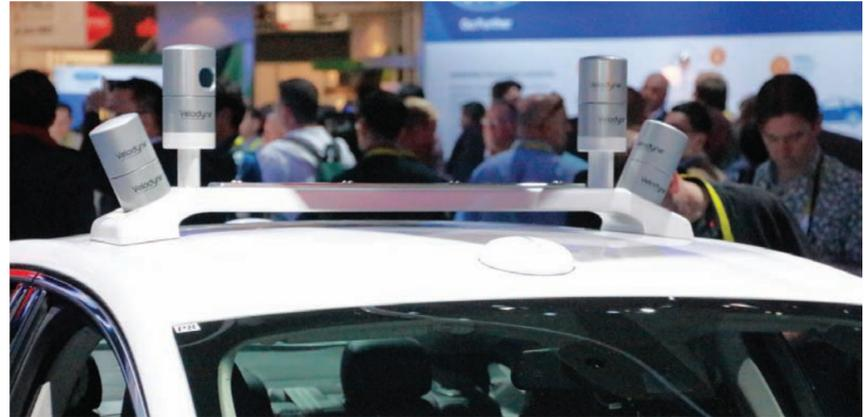
El diseño permitirá reducir la cantidad de sensores LiDAR de Velodyne, de cuatro en la actualidad a dos, y que van en el techo de los nuevos vehículos Fusion Híbridos autónomos. FOTOS: FORD
